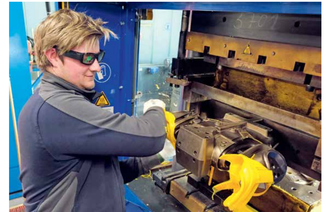
Hightech: Mitarbeiter Nico Werner trainiert die 3-D-Brille bei der Entformung eines Kunststoffartikels.
